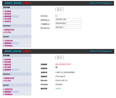
2.2.2、设置为 KNX IP Router 模式:点击"基本设置"→"启动参数",进行网络设置,将"接口类型"选为"By KTS",启动模式选为"KNX Router Mode",之后提交并重启主机网关。
